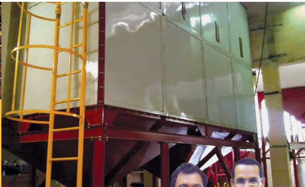
Sistema de armazenamento e blend de crus e torrados. Ao lado, o proprietário Jaime Franco e Lucas da Costa, Gerente de Vendas Nacionais da Cia. Lilla de Máquinas.
